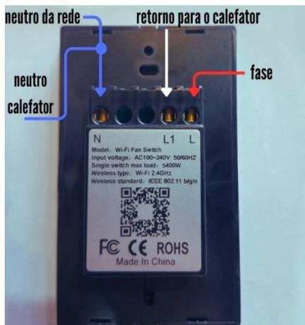
Observação: antes de fazer qualquer ligação elétrica verifique se a mesma se encontra desligada (não energizada), verifique também a tensão de energia antes de fazer a ligação (110V ou 220V). Fazer qualquer ligação elétrica sem os devidos cuidados pode causar risco de morte.
