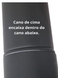
OBS: em todas as emendas na parte externa deverá ser utilizado obrigatoriamente cola silicone alta temperatura para evitar infiltração de água ou que escorra a resina gerada devido a queima da lenha e ainda deverá se utilizar nestas emendas rebites ou parafuso auto brocante para firmar a emenda entre as partes. Quando for instalado o último cano, deverá ser colocado o chapéu e a utilização de rebites ou parafuso auto brocante para fixação do chapéu no cano.
